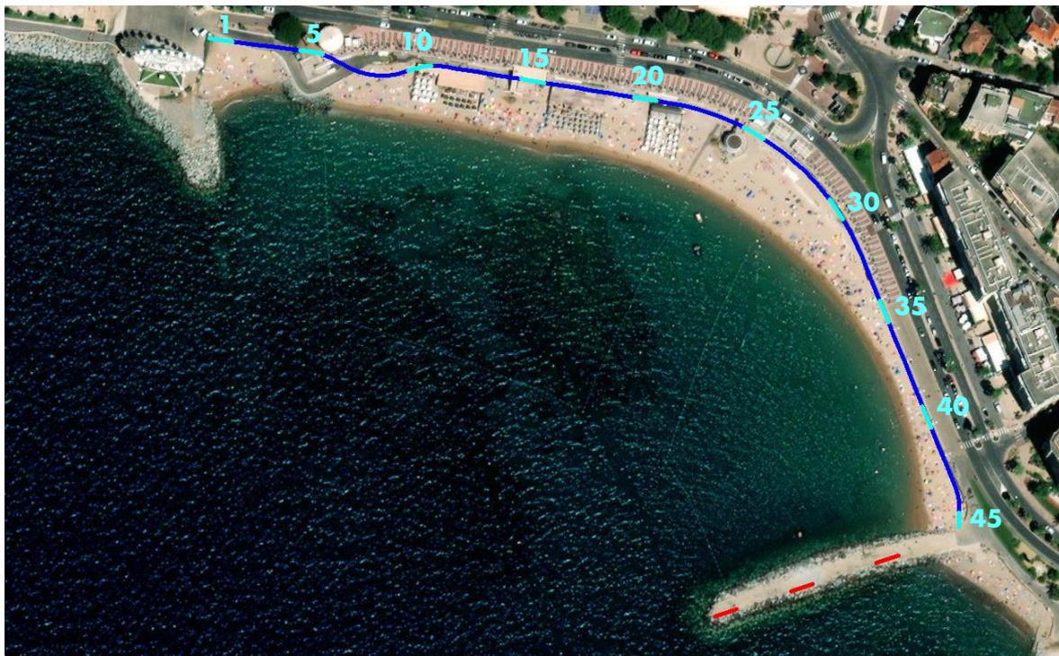
Figure 14 : tracé de la frontière de contrôle du débit moyen de franchissement le long de la promenade en haut de plage. Cette frontière est divisée en 45 segments de contrôle de 10 m chacun.
