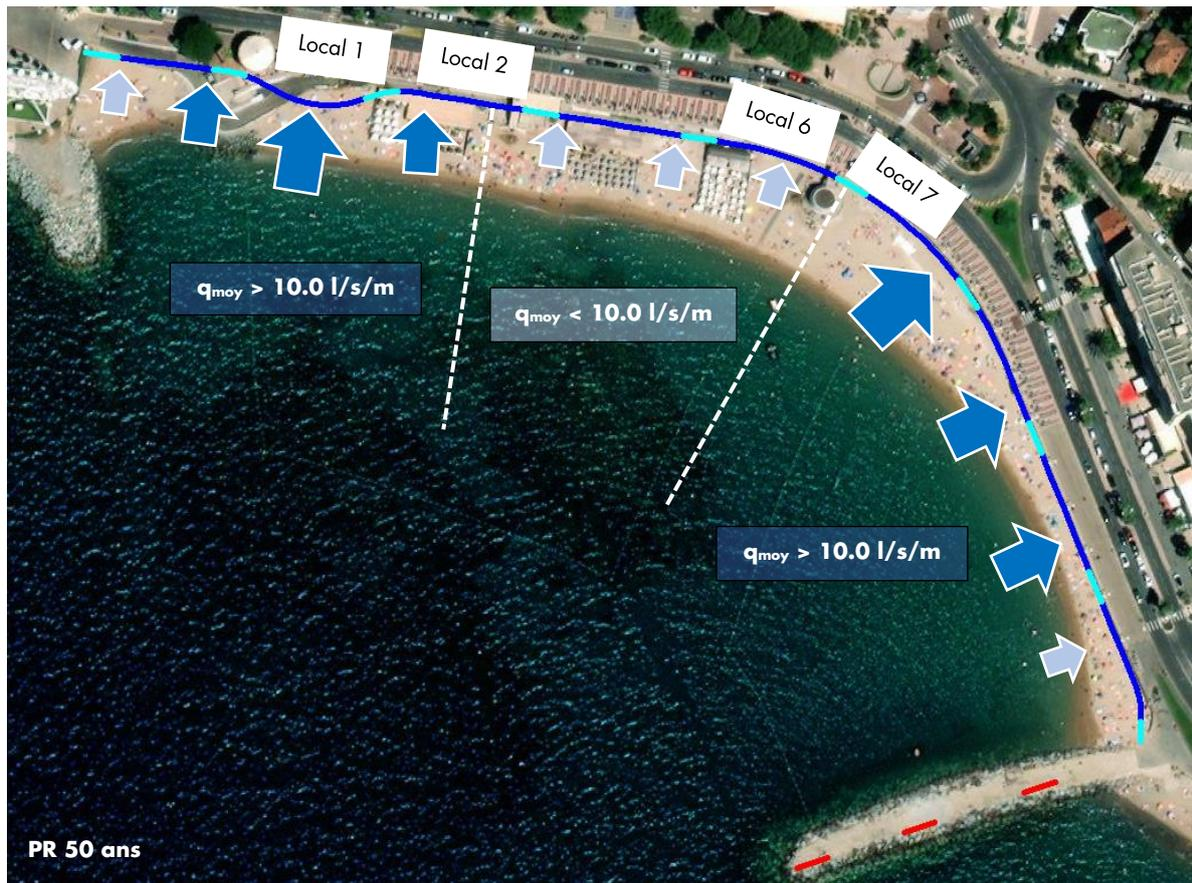
Figure 16 : Répartition schématique des franchissements et de leur intensité en conditions de PR 50 ans
